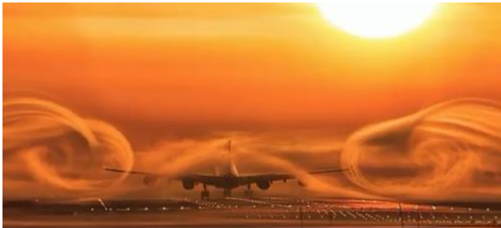
Рис.2. Образование вихрей при взлете.
