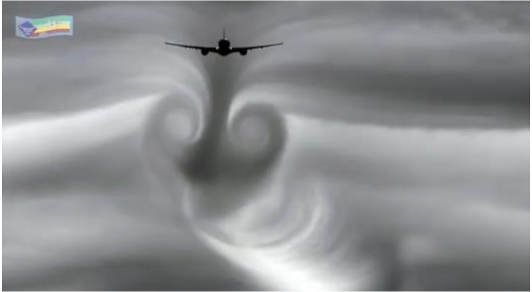
Рис. 1 Аэродинамические вихри, связанные с подъемной силой крыла самолета
