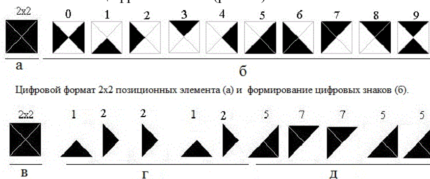
Отображение цифровых знаков ориентированных в пространстве при их формировании на 5-раздном индикаторе (г - 12212, д - 57755).
